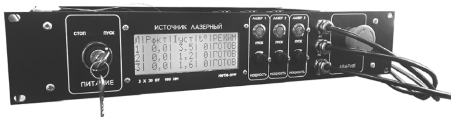
Рис. 2. Блок питания и управления лазерными диодами для волоконно-оптической системы энергоснабжения (разработка МФТИ)
