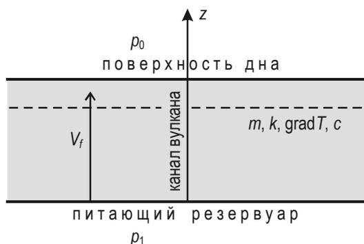
Принципиальная схема условий фильтрации газонасыщенного флюида и зоны устойчивости газовых гидратов в окрестностях грязевого вулкана
